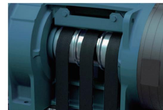
扁平的复合钢带作用于平滑的曳引轮轴。钢带表面采用聚氨酯材料层，减少传统钢丝绳与主机之间的摩擦，有效降低运行中的震动和周边环境噪音。
