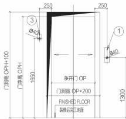
(所有层) 厅门图(FRONT VIEW)
