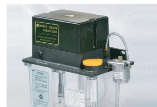
采用微机控制的自动润滑系统，定时为扶梯的各个主要部位添加适量的润滑油，保证链条滚轮在运行时噪音低、振动小，有效地延长了链条滚轮的使用寿命。
