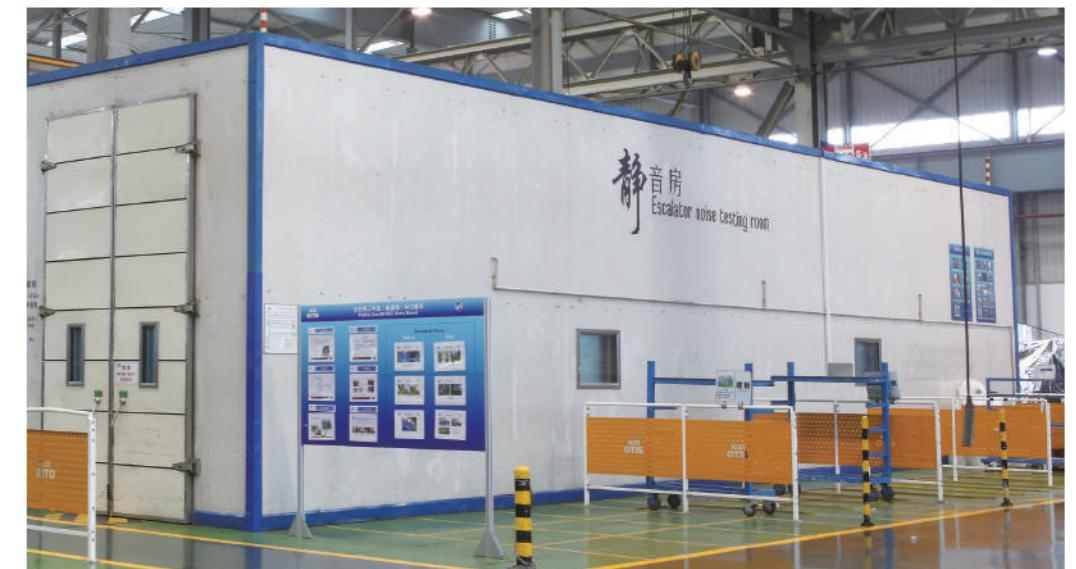
通过DSP信号处理芯片记录噪音文件进行处理分析，诊断设备故障。
